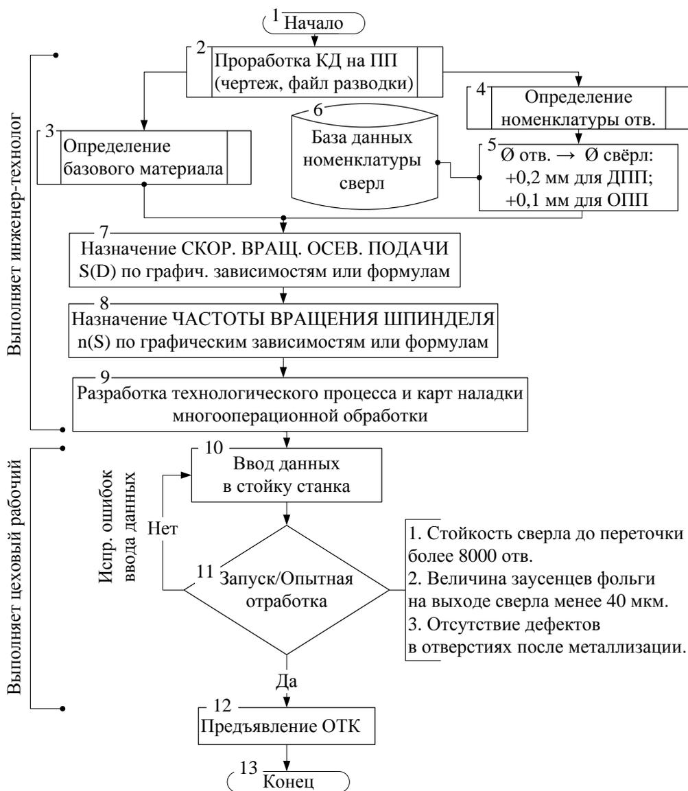
Рис. 7 Назначение режимов резания
