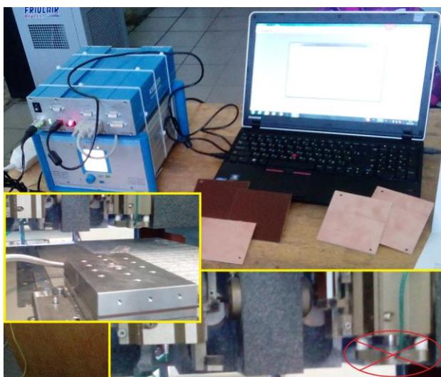
Рис. 3 Рабочее место с динамометром Kistler и блоком управления и анализа
