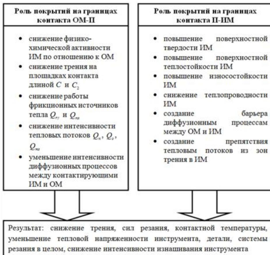
Рис. 1.1. Обобщенное представление о роли износостойкого покрытия режущего инструмента [17]: ОМ – обрабатываемый материал, П – покрытие, ИМ – инструментальный материал
