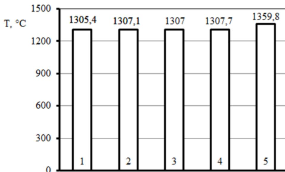
Рис. 3.3. Температура на поверхности пластины МК8 при плотности мощности  $6000 \text{ Вт/см}^2$ :
