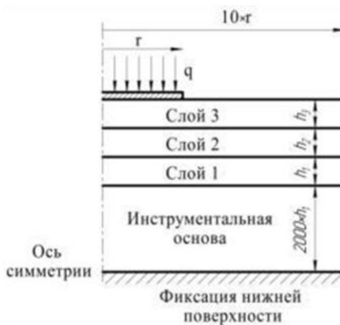
Рис. 3.9. Схема воздействия лазерного излучения на пластину
