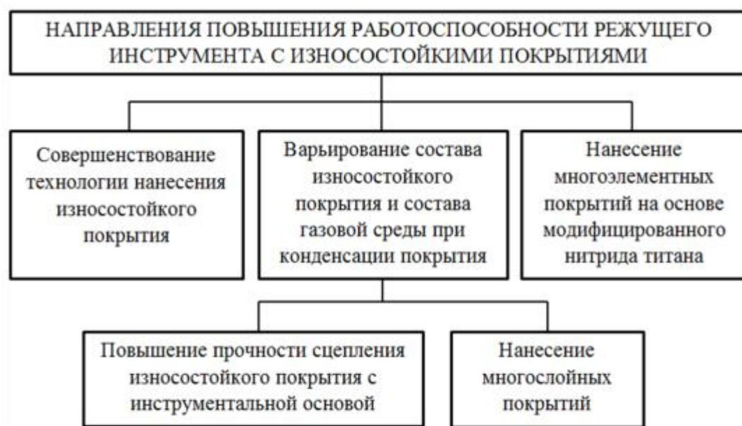
Рис. 1.3. Направления совершенствования режущего инструмента с износостойкими покрытиями [62]
