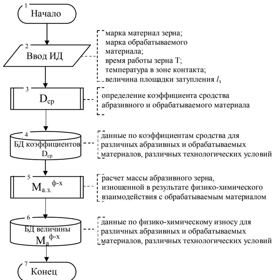
Рисунок 3.6.2 – Алгоритм расчета износа абразивного зерна в результате физико-химического взаимодействия с обрабатываемым материалом
