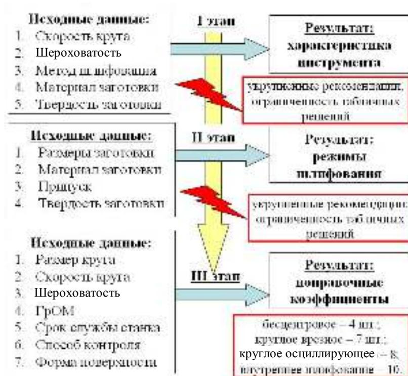
Рисунок 1.2.1 – Порядок проектирования операций шлифования по справочнику [218]
