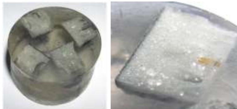
Рисунок 3.3.3 – Образцы с напылением перед исследованием под микроскопом
