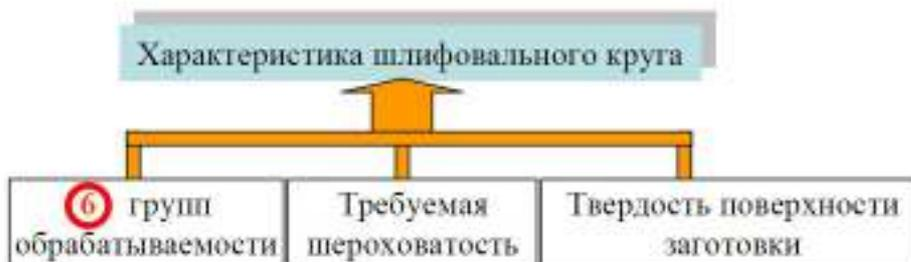
Рисунок 7.1.1. Структура методики назначения характеристики ШК в справочнике 1978 г. [218]
