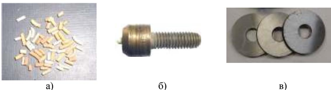
Рисунок В.2 – Исходные материалы: а) формокорунд; б) единичное зерно в оправке; в) образец
