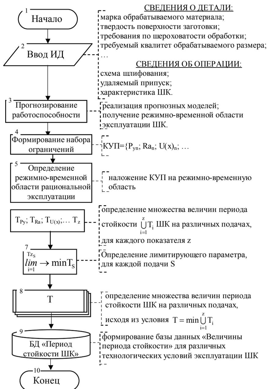
Рисунок 5.2.1 Алгоритм определения величины периода стойкости ШК
