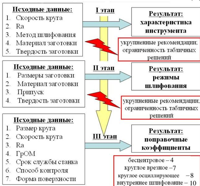
Рис. 1. Порядок проектирования операций шлифования по справочникам ОМН
