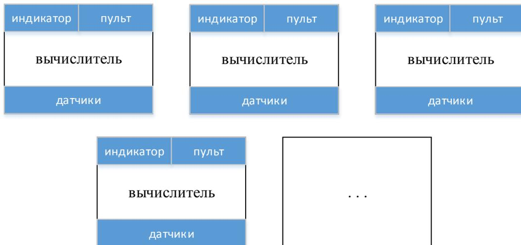
Рисунок 1 - Типовая схема КБО первого типа
