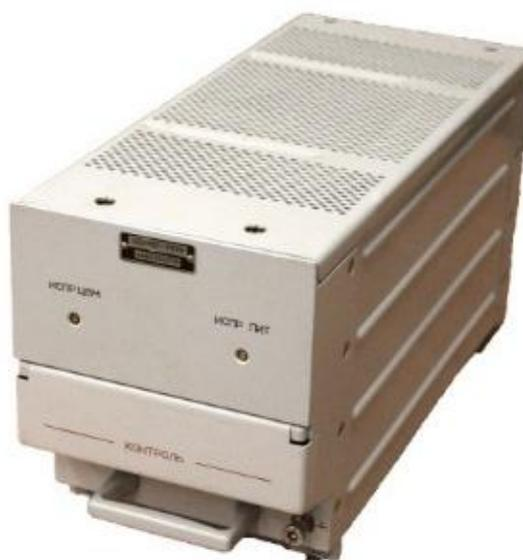
Рисунок 8 – «БЦВМ 80-3000» образца 1980 года, производства АО «ОКБ «Электроавтоматика» [10]
