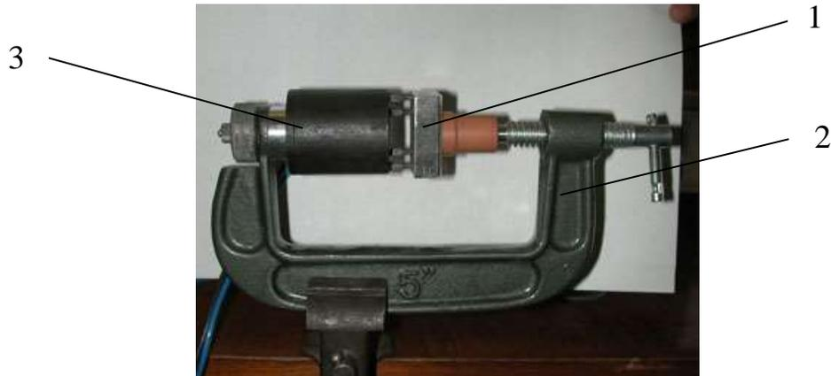
Рис. 3.2. Схема закрепления исследуемого образца: 1 – заготовка; 2 – державка; 3 - датчик
