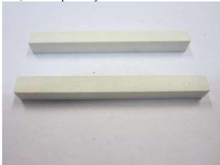
Рис. 2.2. Абразивные бруски 20x20x150 25A F60 М 5 V А
