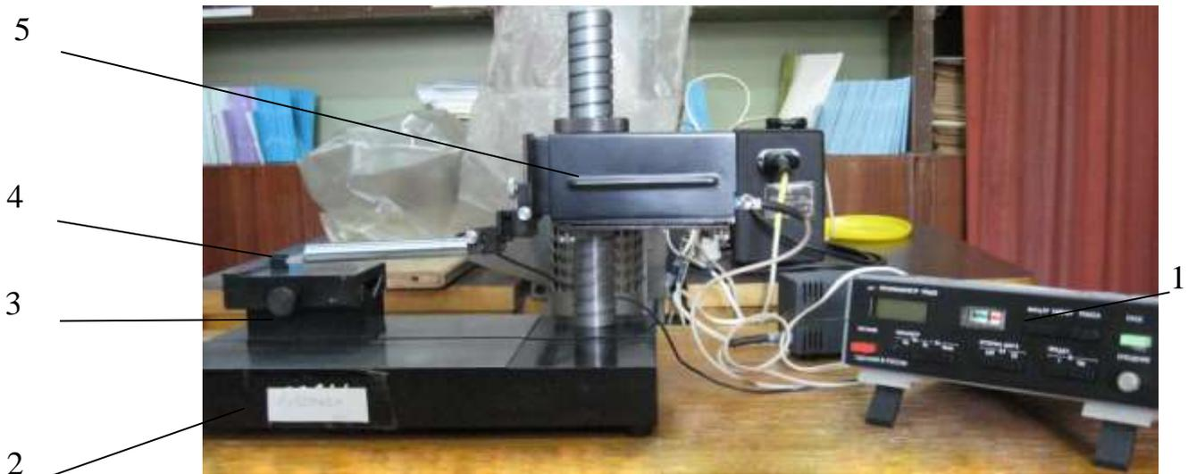
Рис. 3.1. Общий вид профилометра мод. 170622: 1 – блок электронный; 2 – стойка; 3 – призма; 4 – датчик; 5 – привод
