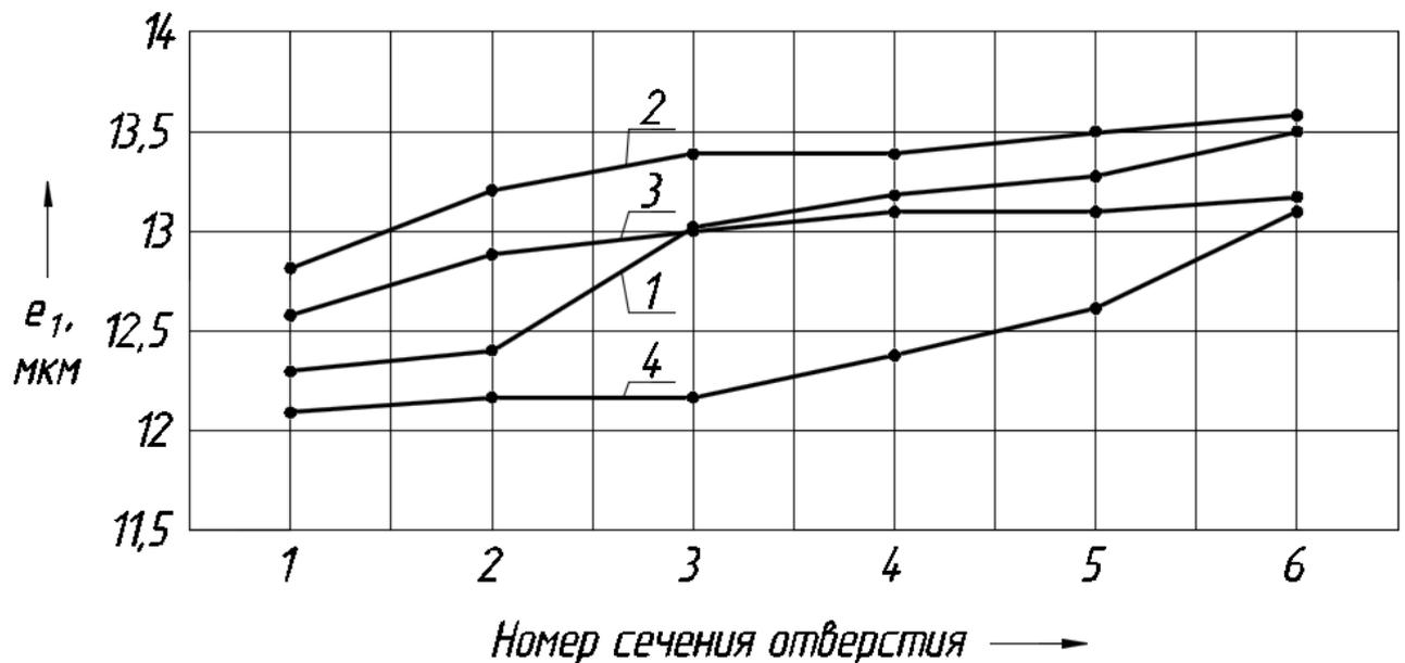
Рисунок 5.6 – Графическое изображение увода центра отверстий от изгибных деформаций станины  $e_1$ , без системы компенсации угловых перемещений стойки при деформации станины горизонтального КРС, где: 1 – отверстие №8; 2 – отверстие №24; 3 – отверстие №40; 4 – отверстие №56
