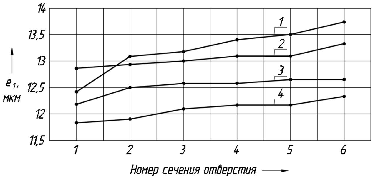
Рисунок 5.7 – Графическое изображение увода центра отверстий от изгибных деформаций станины  $e_1$ , без применения системы компенсации угловых перемещений стойки при деформации станины горизонтального КРС, где: 1 – отверстие №16; 2 – отверстие №32; 3 – отверстие №48; 4 – отверстие №64
