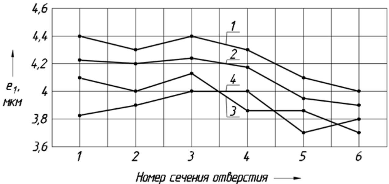
Рисунок 5.10 Графическое изображение увода центра отверстий от изгибных деформаций станины  $e_1$ , с применением системы компенсации угловых перемещений стойки при деформации станины горизонтального КРС, где: 1 – отверстие №8; 2 – отверстие №24; 3 – отверстие №40; 4 – отверстие №56
