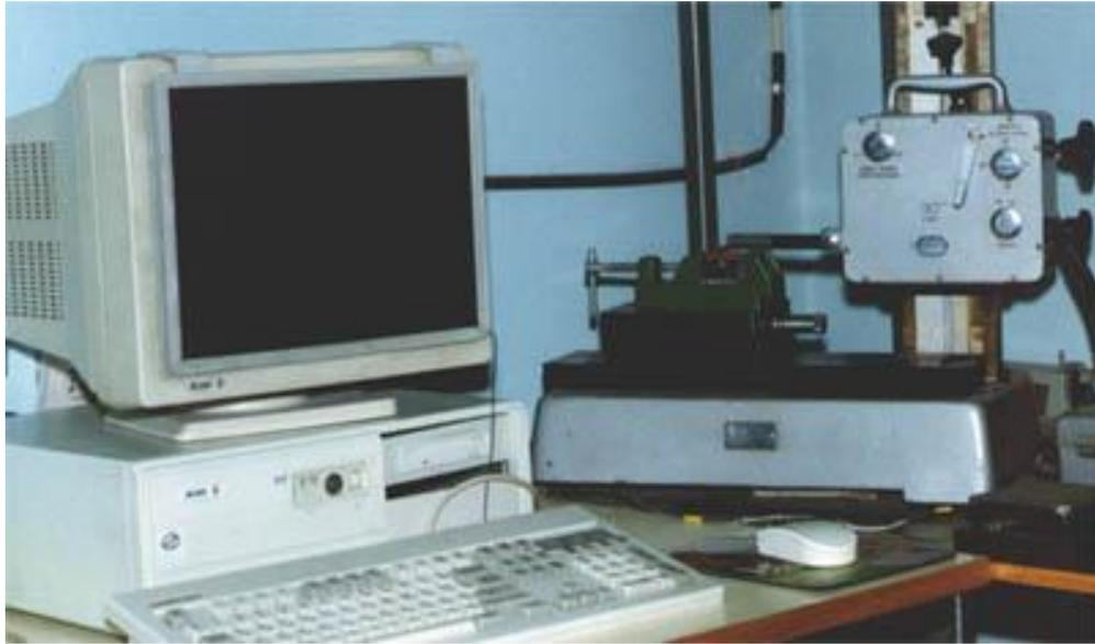
Рисунок 4.7. Измерение шероховатости на профилометре 296
