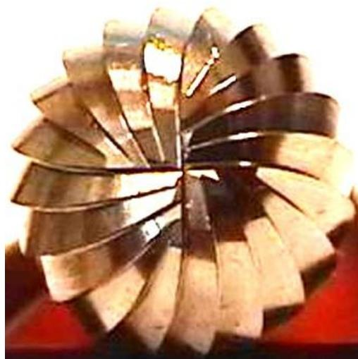
Рисунок 1.14. Конструкция сферических фрез с групповыми зубьями
