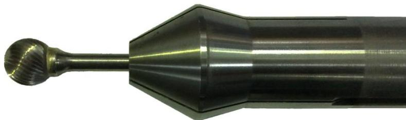
Рисунок 4.3. Изготовленная сферическая фреза
