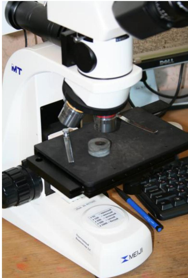
Рисунок 4.6. Внешний вид инструментального микроскопа
