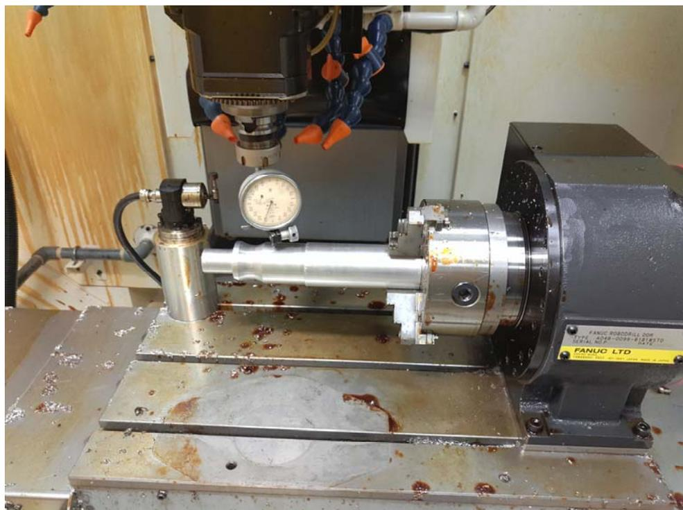
Рисунок 4.7 Контроль радиального и торцового биения на станке
