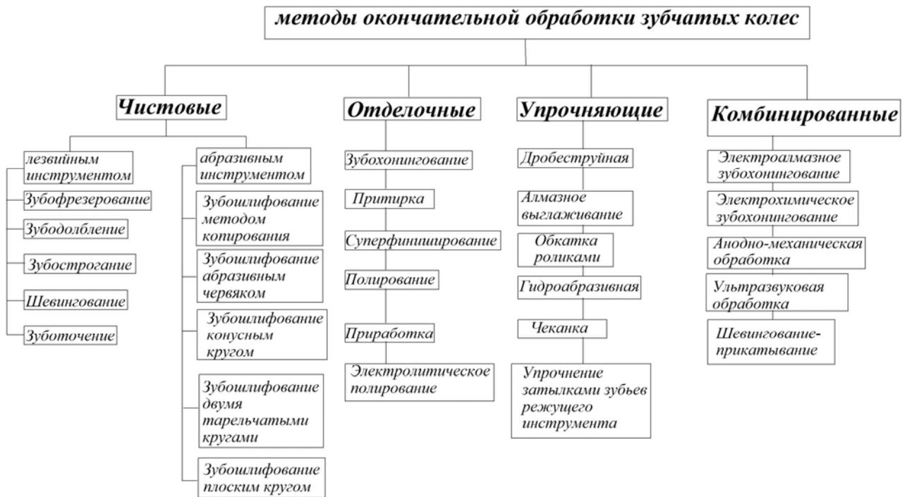
Рисунок 1.11. Методы финишной обработки зубьев зубчатых колес
