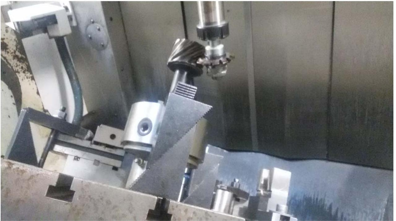
Рисунок 4.12. Обработка дисковой модульной фрезой гиперболических зубчатых с зубьями двойной кривизны на многокоординатном станке с ЧПУ.
