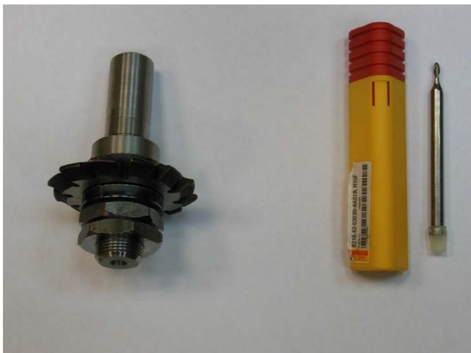
Рисунок 4.12. Используемый металлорежущий инструмент - оправка с дисковой модульной фрезой и концевая фреза
