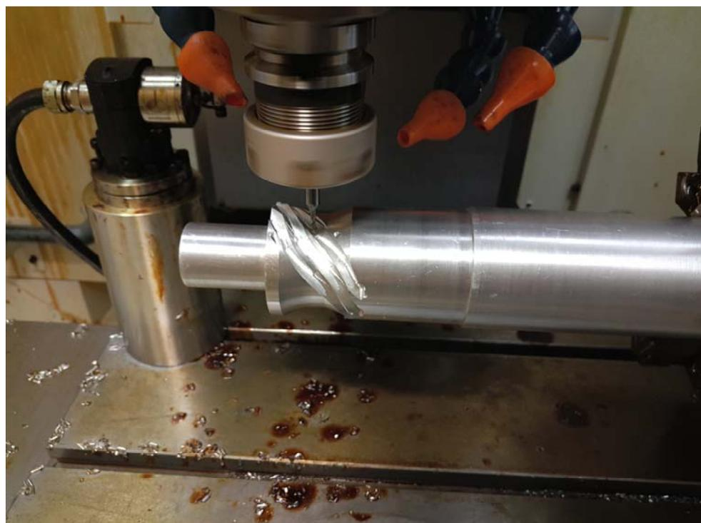
Рисунок 4.10. Чистовое формообразование зубьев фрезерованием на станке с ЧПУ.
