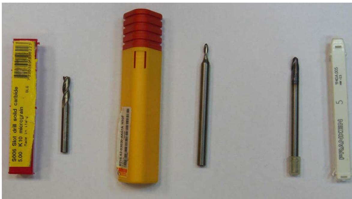
Рисунок 4.8. Используемые для формообразования зубьев концевые фрезы
