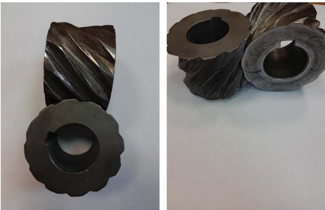
Рисунок 4.13. Изготовленные зубчатые колеса
